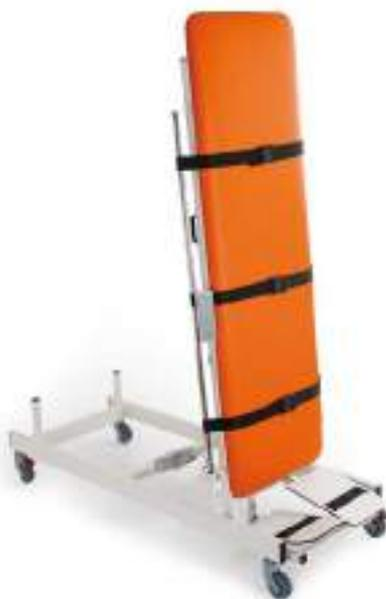
Tavolo di statica ad una sezione ad altezza fissa. L'inclinazione è regolabile elettricamente da 0° a 90° mediante pulsantiera. Dotato di tre cinghie ferma paziente e pedane poggiapiedi indipendenti e regolabili mediante molle a gas. Il lettino è costruito in modo da consentire il passaggio sollevatore. Rivestimento disponibile in vari colori. Portata max 150 Kg distribuiti uniformemente.
