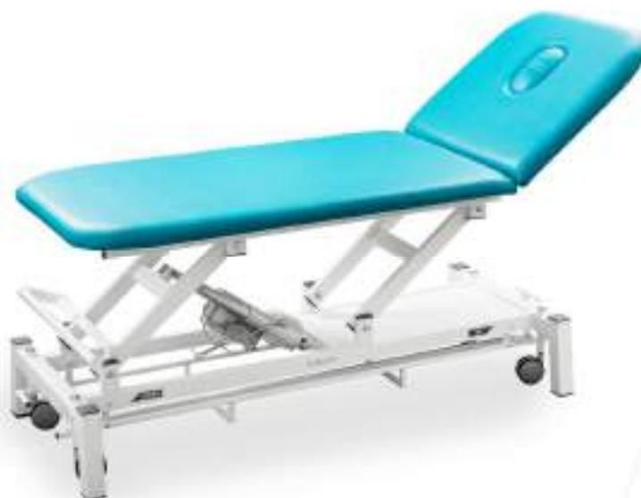
Letto a due sezioni con schienale regolabile mediante asta a cremagliera da 0° a 45° (oppure con molla a gas optional da -35° a +85°). Altezza regolabile con motore da 6000N. Foro per il viso con tappo di serie. Possibilità di scelta testata unica o con braccioli. Rivestimento cuscino in skai lavabile e ignifugo classe 11M. Piedini regolabili e antiscivolo. Portata max 180 Kg.
