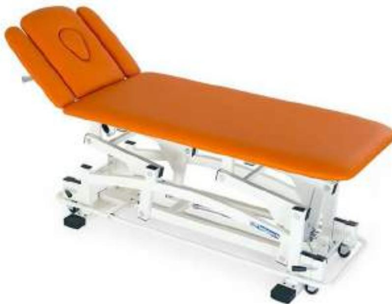
Letto a 4 segmenti, regolabile in altezza elettricamente da 45 a 90 cm mediante comando a pedale. La testata è regolabile da +60° a -20° mediante pistone a gas con appoggia braccia regolabili. Foro viso con tappo. Piano imbottito e rivestito in similpelle lavabile, antibatterico/antiacaro ed ignifugo Classe 11M. Portata max 200 Kg distribuiti uniformemente. Rivestimento disponibile in diversi colori.
