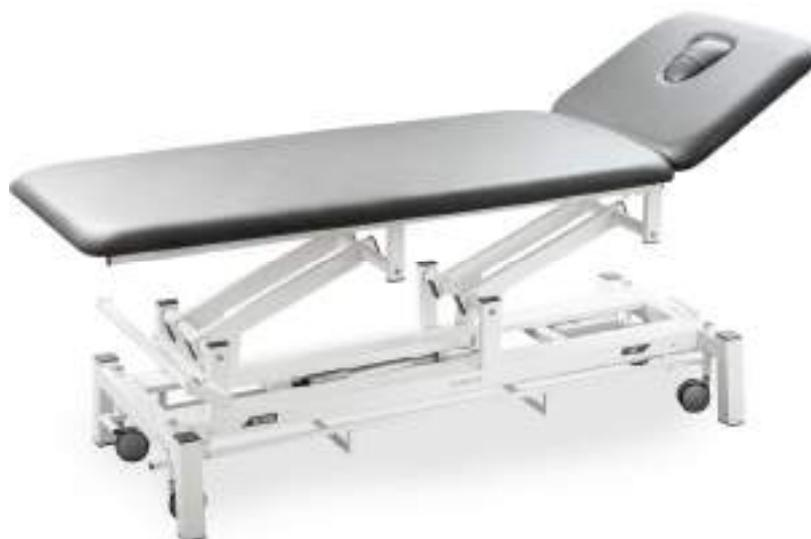
Letto a due sezioni con sezione testa regolabile tramite molla a gas da  $-35^{\circ}$  a  $+45^{\circ}$ . Altezza regolabile con motore elettrico da 8000N. Foro per il viso con tappo di serie. Possibilità di scelta testata unica o con braccioli. Rivestimento cuscino in skai lavabile e ignifugo classe 11M. Piedini regolabili e antiscivolo. Portata max 200 Kg.
